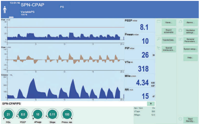
Fig. 1 Écran en mode SPN-VSPEP/AI avec aide inspiratoire variable
