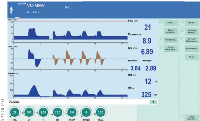
Fig. 2 (VC-VIV + AF avec respiration imposée et respiration spontanée)
