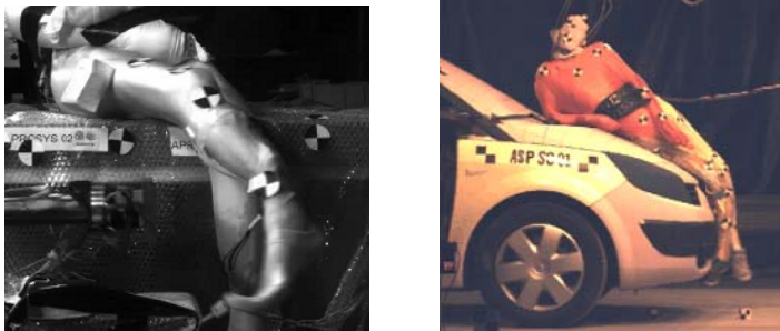
Figure 4.- Analyse locale des processus de rupture de la jambe lors d'un choc latéral occupant et réalisation d'un impact moto pleine échelle
