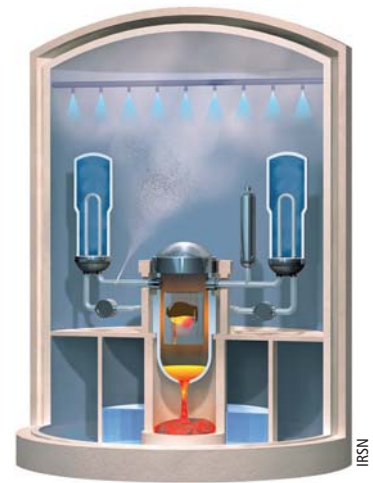
Simulation d'un accident de fusion du cœur d'un réacteur à eau sous pression par le logiciel Astec.
